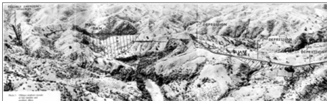
Fig. 5.9 FOTO AÉREA OBLICUA DEL SITIO DE LA PRESA CON LA PRESA SUPERPUESTA FOTO TOMADA AGUAS ARRIBA
